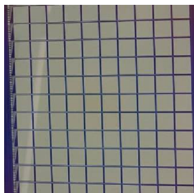
Рис. 1. Сенсор на основе HR GaAs:Cr
