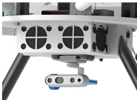
Рис. 3. ИИ-камера Intel RealSense D435 в составе БПЛА
