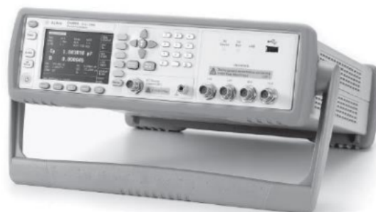
Рис. 1. Универсальный измеритель LCR Agilent E4980A
