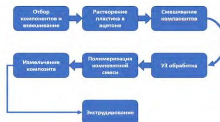
Рис. 1. Технология производства филамента
