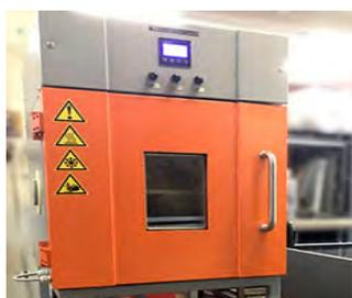
Fig. 2. The climate test chamber «SPC Technology» [2]
