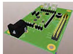
Рис. 3. Печатный узел устройства управления элементом Пельтье
