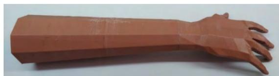
Рис. 2. Фантом взрослой руки, изготовленный из ABS пластика
