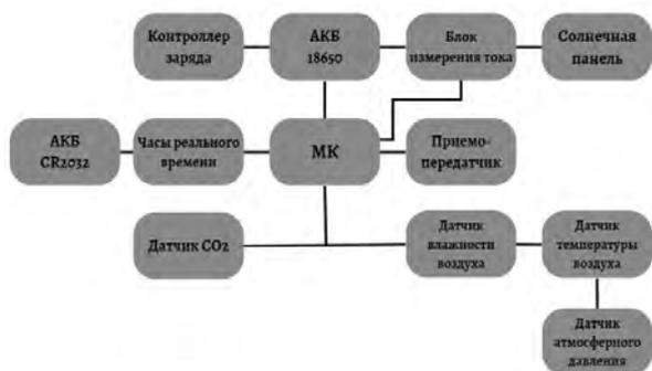
Рис. 1. Структура устройства сбора данных о концентрации углекислого газа
