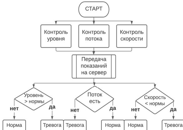
Рис. 1. Блок-схема алгоритма работы системы контроля
