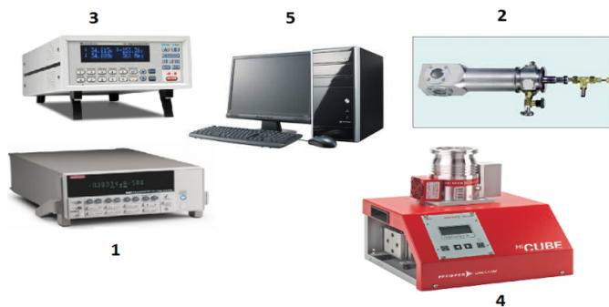
*Рис. 1. Измерительный комплекс: 1 – пикоамперметр Keithley 6487, 2 – вакуумный криостат Janis, 3 – контроллер температуры Lakeshore 335, 4 – вакуумный пост HiCUBE, 5 – персональный компьютер*
